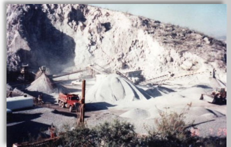
La misma mina tres meses después con el sistema de Niebla Seca.
